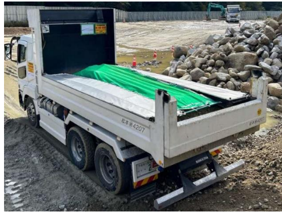
写真4-1-170 荷台への防じんシート敷設
