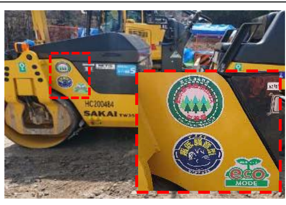
写真4-1-154 排出ガス対策型、低騒音型 建設機械の採用
