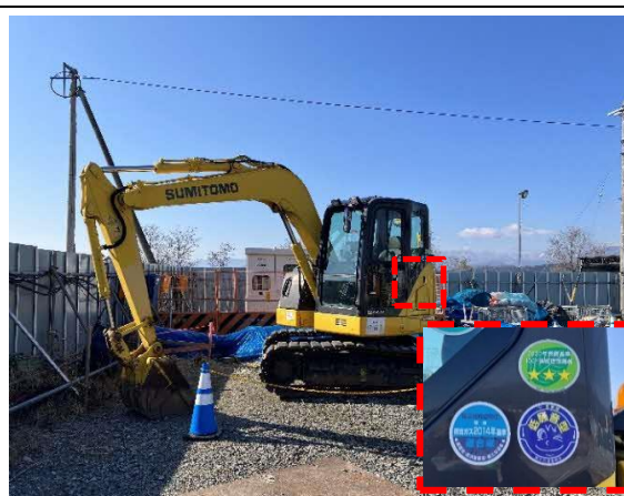
写真4-1-98 排出ガス対策型、低騒音型建設機械の採用
