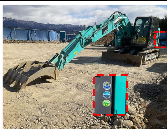
写真4-1-122 排出ガス対策型、低騒音型 建設機械の採用
