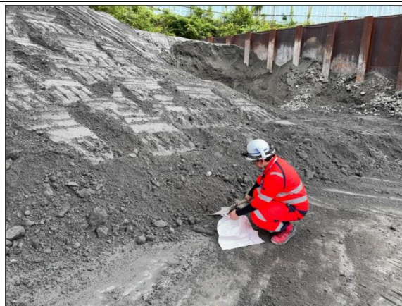
写真4-1-60 重金属等溶出試験試料採取 の状況
