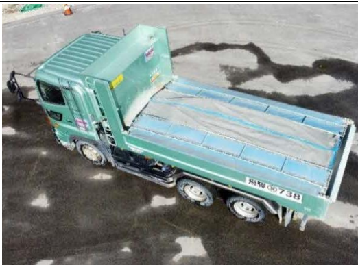
写真4-1-189 荷台への防じんシート敷設
