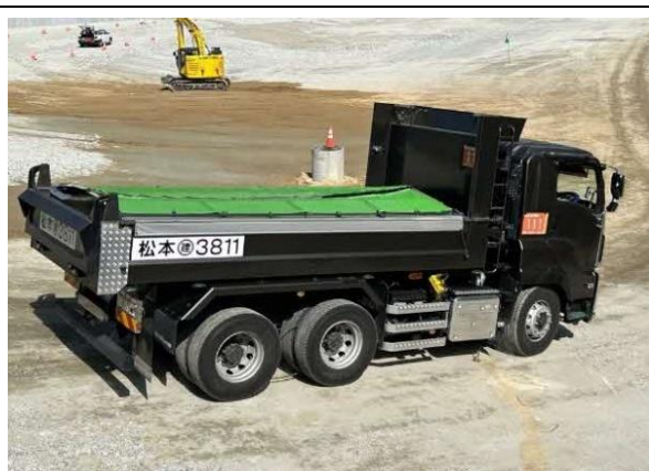
写真4-1-207 荷台への防塵シート敷設
