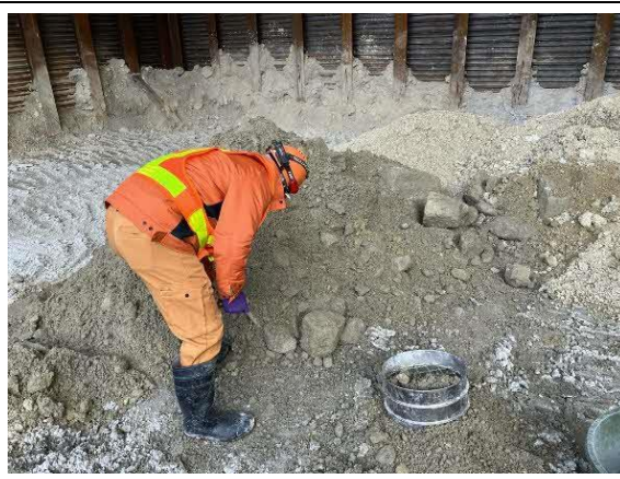
写真4-1-184 重金属等溶出試験試料採取の状況
