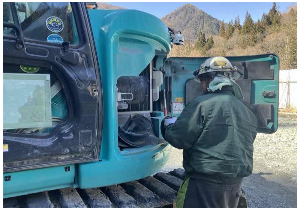
写真4-1-191 建設機械の点検及び整備に よる性能維持
