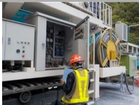
写真4-1-27 建設機械の点検及び整備に よる性能維持
