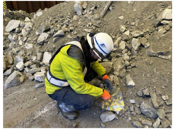
写真4-1-164 重金属等溶出試験試料採取の状況
