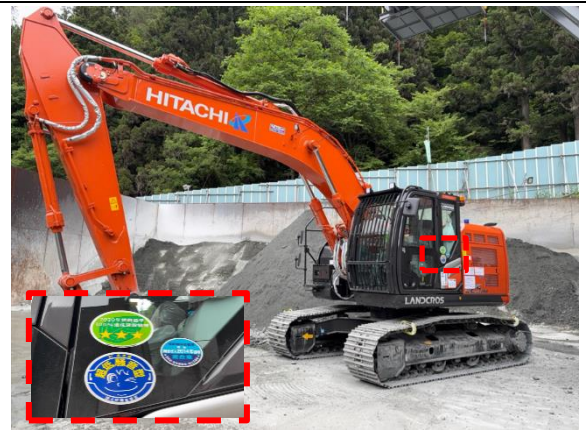
写真4-1-49 排出ガス対策型、低騒音型 建設機械の採用
