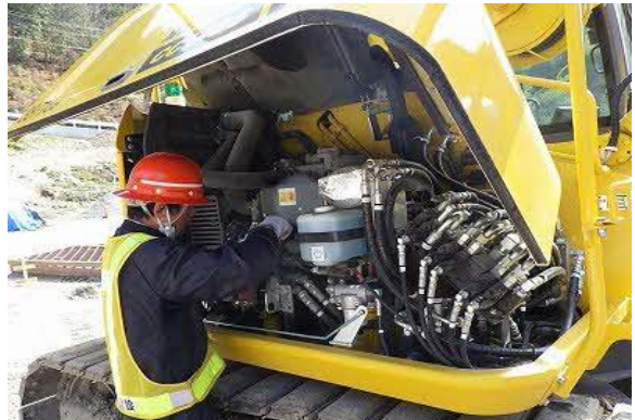
写真4-1-70 建設機械の点検及び整備に よる性能維持
