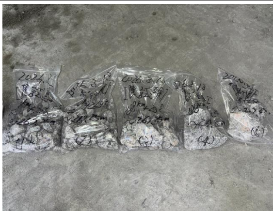
写真4-1-142 重金属等溶出試験試料採取の状況
