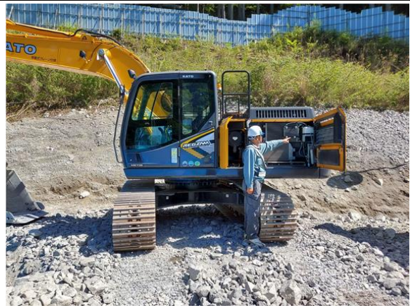
写真4-1-210 建設機械の点検及び整備に よる性能維持
