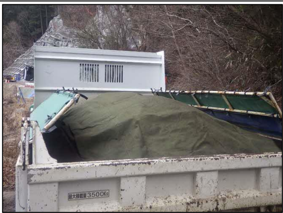
写真4-1-66 荷台への防じんシート 敷設
