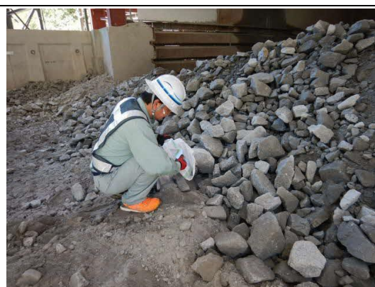
写真4-1-78 重金属等溶出試験試料採取 の状況
