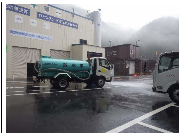
写真4-1-5 工事現場の散水状況
