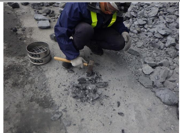
写真4-1-14 重金属等溶出試験試料採取の状況
