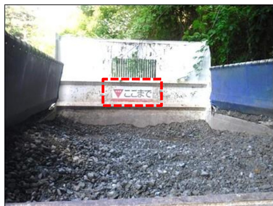
写真4-1-61 積載の効率化（積載目安線）（一例）
