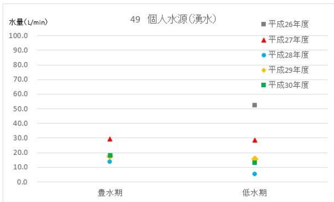
図 3-4-4-1(10) 地下水の水位及び湧水の水量の調査結果 (49 大鹿村 個人水源 (湧水))
