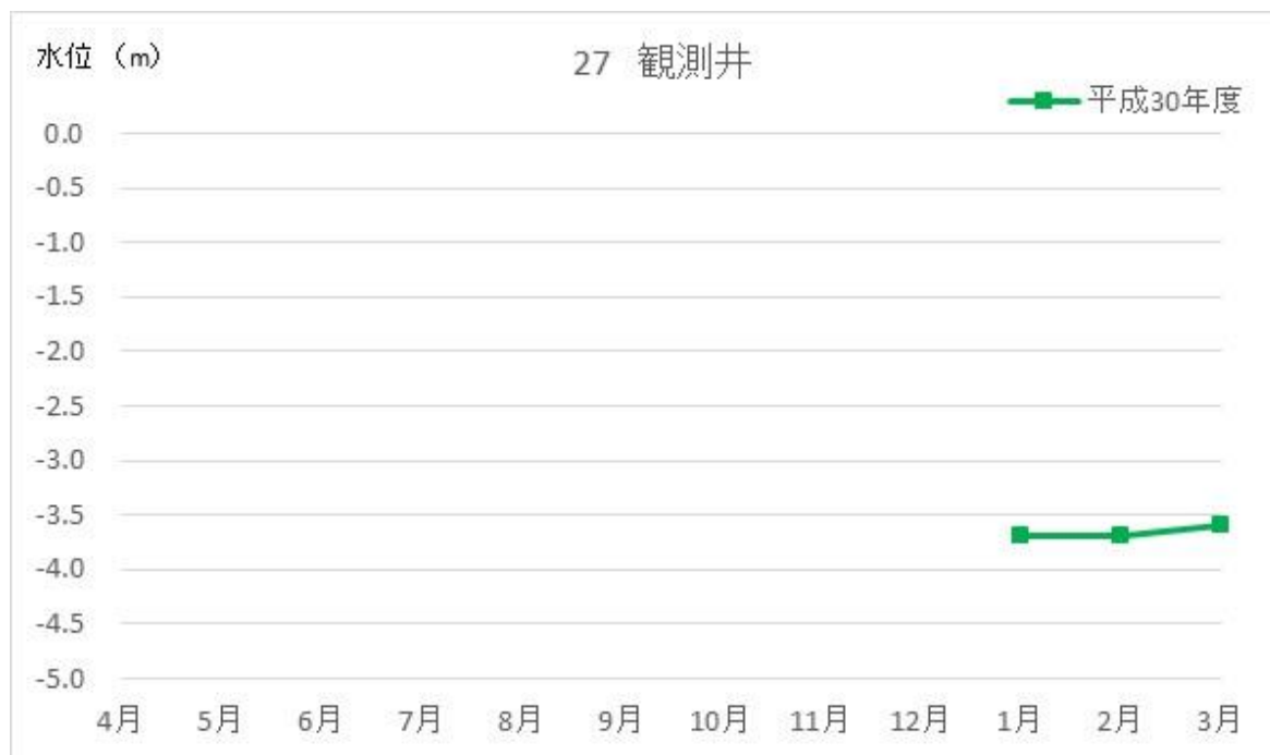
図 3-4-4-1 (24) 地下水の水位及び湧水の水量の調査結果 (27 飯田市 観測井)
