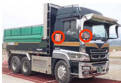
工事用車両の明示
