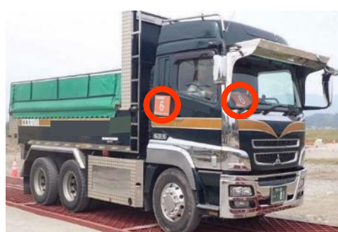
工事用車両の明示
