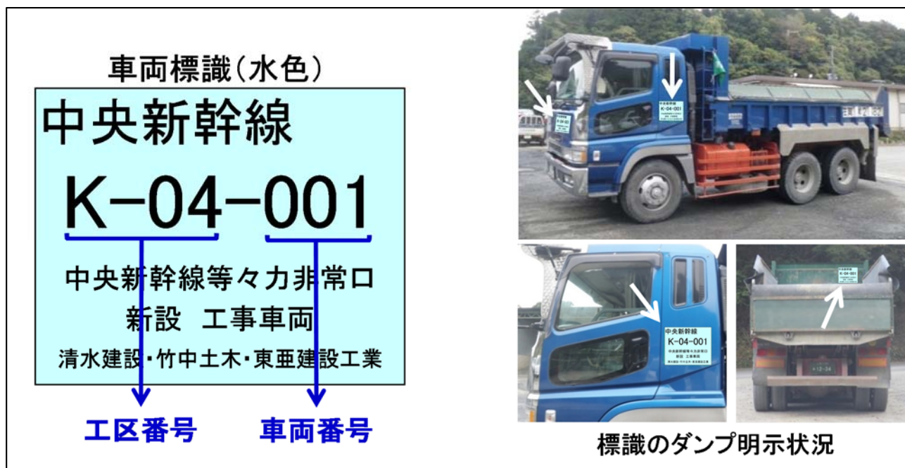
図 3-5 工事用車両標識の明示
