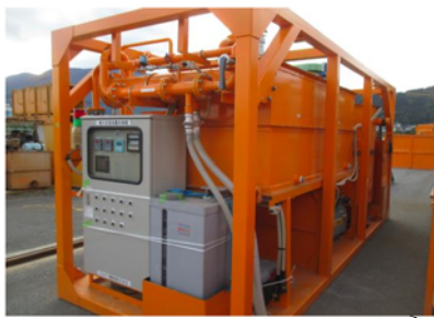
写真①濁水処理設備の設置 (ヤード内に設置)
