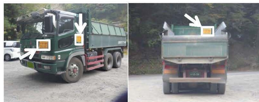
ダンプトラックの標識の明示状況
