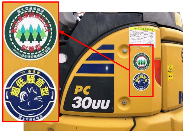
写真 4-1-9-1 排出ガス対策型建設機械の採用 低騒音型建設機械の採用
