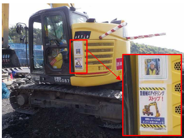
写真4-1-8-5 建設機械の使用時における配慮 (重機械運転者にアイドリング ストップを促す看板の設置)
