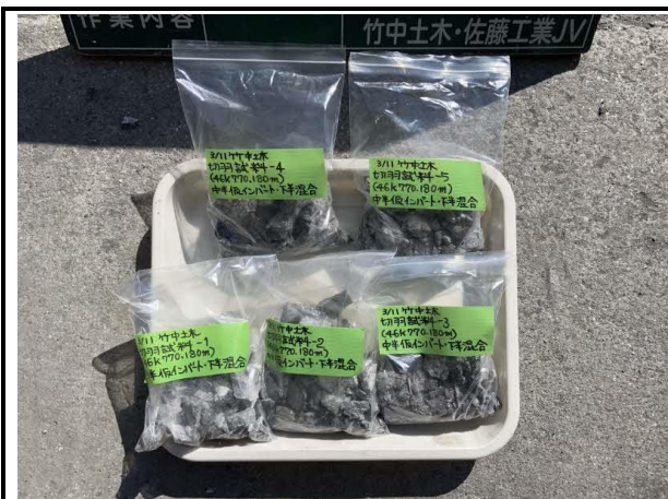
写真4-1-10-13 発生土に含まれる自然由来の 重金属等の定期的な調査
