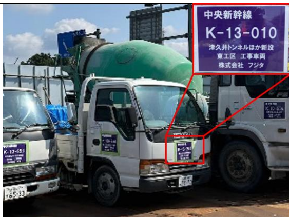
写真 4-1-9-17 工事に使用する道路、 搬入時間及び法定制限速度の遵守 (車両標識明示による安全運転意識の向上)
