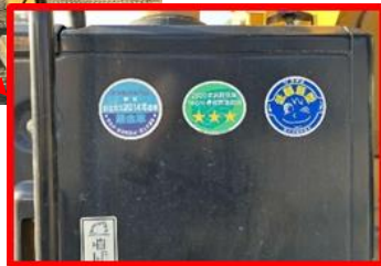
写真4-1-5-2 排出ガス対策型建設機械の採用 低騒音型建設機械の採用
