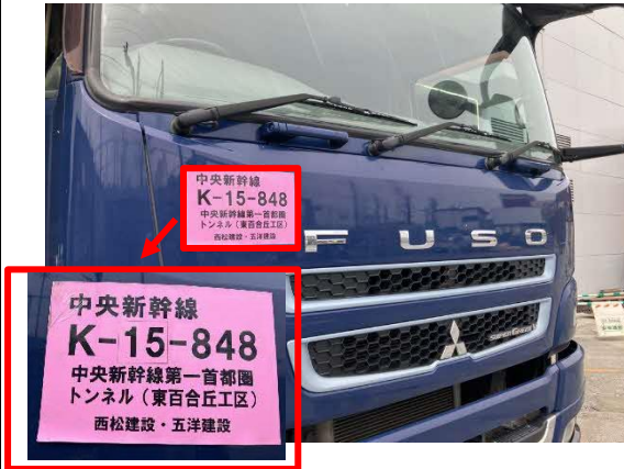
写真 4-1-4-14 工事に使用する道路、 搬入時間及び法定制限速度の遵守 (車両標識明示による安全運転意識の向上)
