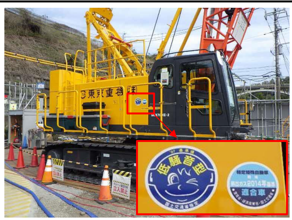
写真4-1-8-2 排出ガス対策型の建設機械の採用 低騒音型建設機械の採用
