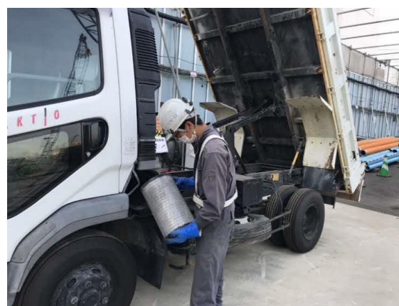
写真4-1-3-12 資材及び機械の運搬に用いる車両の点検 及び整備による性能維持、車両整備の徹底
