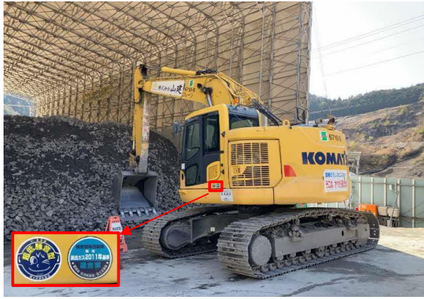
写真4-1-12-1 排出ガス対策型建設機械の採用 低騒音型建設機械の採用
