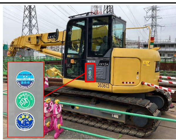
写真4-1-7-2 排出ガス対策型建設機械の採用 低騒音型建設機械の採用
