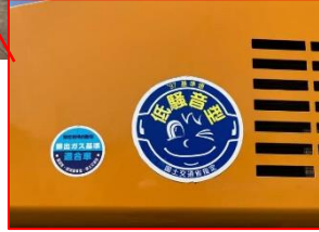
写真4-1-6-1 排出ガス対策型建設機械の採用 低騒音型建設機械の採用
