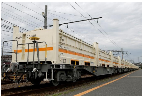
写真4-1-2-11 貨物列車を活用した発生土の運搬
