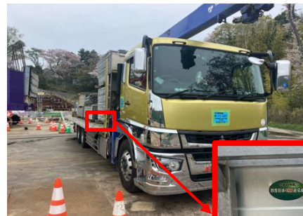
写真4-1-5-1(2) 仮囲い・防音シート等の設置 (エンジン周りに防音シートを設置)
