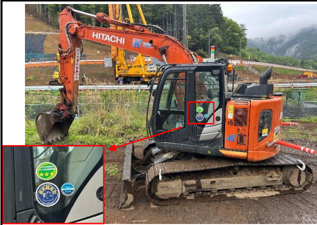
写真 4-1-11-1 排出ガス対策型建設機械の採用 低騒音型建設機械の採用 低燃費車種の選定
