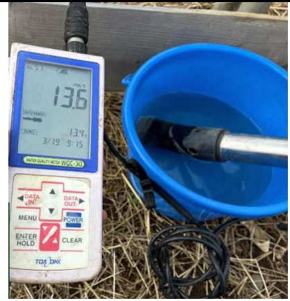
写真4-1-11-8 工事排水の監視
