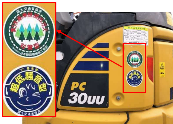
写真 4-1-8-1 排出ガス対策型建設機械の採用、 低騒音型建設機械の採用
