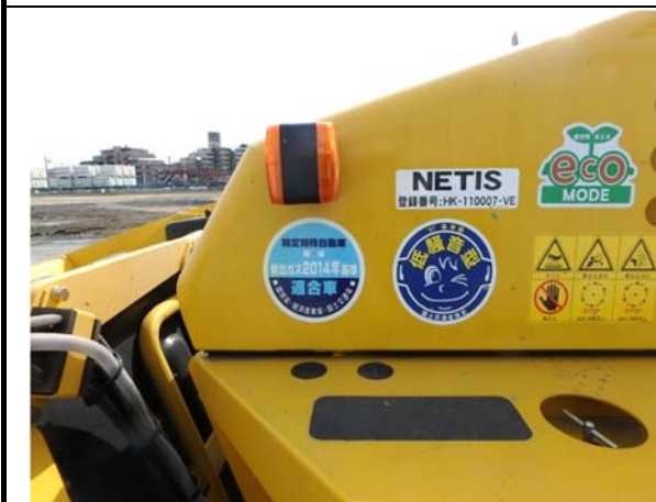
写真 4-1-2-2(1) 排出ガス対策型建設機械の採用 低騒音型建設機械の採用
