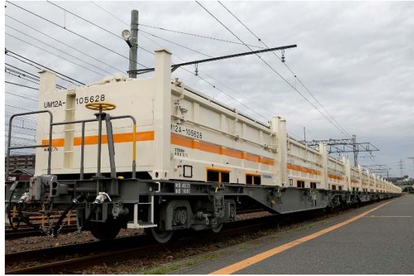
写真 4-1-2-11 貨物列車を活用した発生土の運搬
