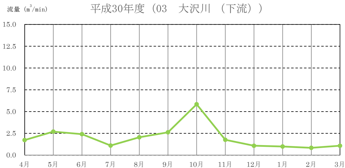
図 2-1-4-2(3) 地表水の流量の調査結果 (03 相模原市 大沢川 (下流))
