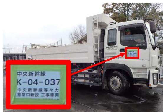
写真 4-1-1-12 工事に使用する道路、 搬入時間及び法定制限速度の遵守 (車両標識明示による安全運転意識の向上)
