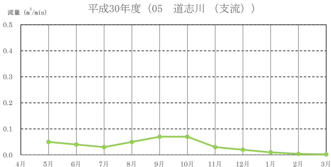
図 2-1-4-2(5) 地表水の流量の調査結果 (05 相模原市 道志川 (支流))
