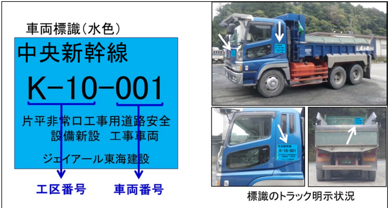
図 3-3 工事用車両標識の明示
