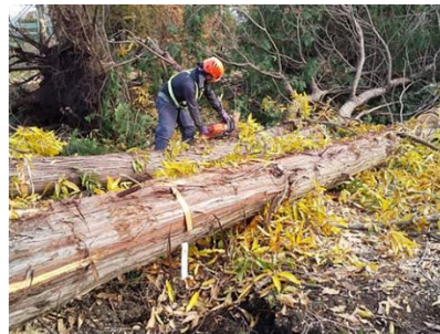
●枝払い ●玉切り 設定した長さまで木材を送り出し、チェーンソーで切り揃える。
