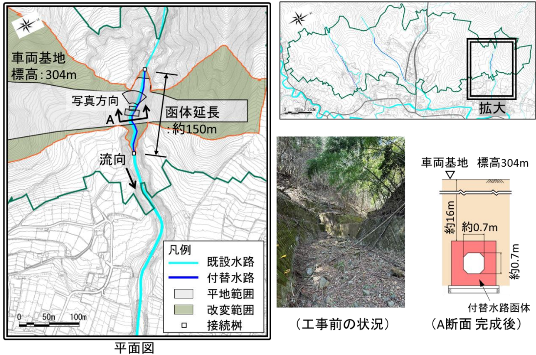
図 2-3-3-1 付替水路工（山ノ神沢）の施工概要
