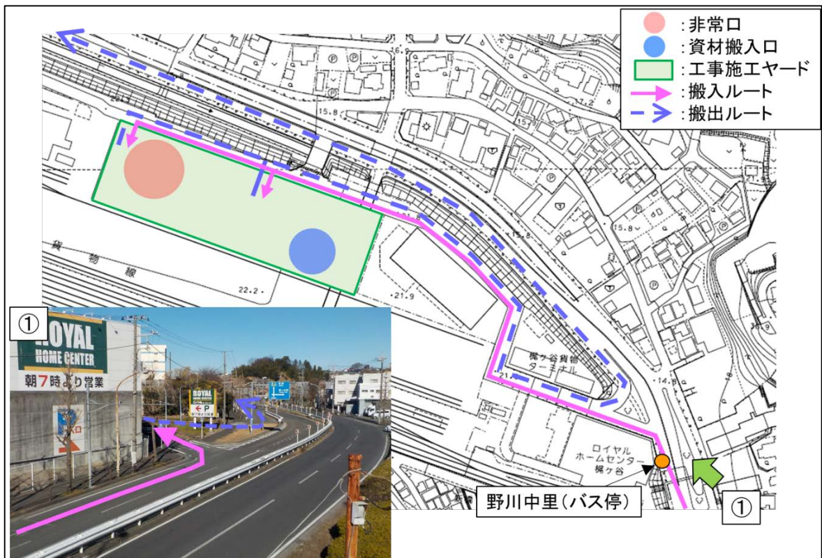
図 2-7(2) 工事用車両の主な運行ルート (詳細)
