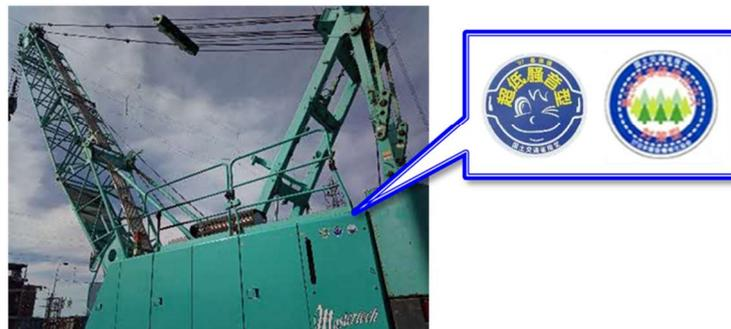
写真③ 排出ガス対策型、低騒音型建設機械の使用
