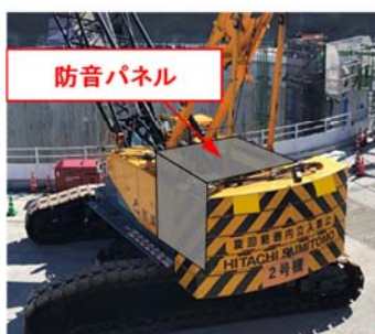
写真③ 建設機械のエンジン部に 防音パネルを設置
