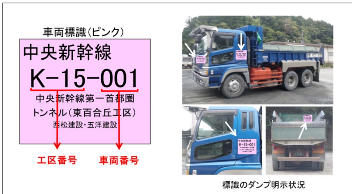
図 3-4 工事用車両標識の明示
