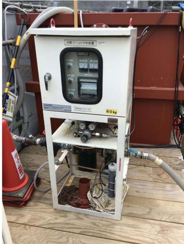
写真① pH中和処理設備の設置
