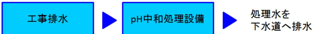
図 3-4 pH 中和処理のフロー図
