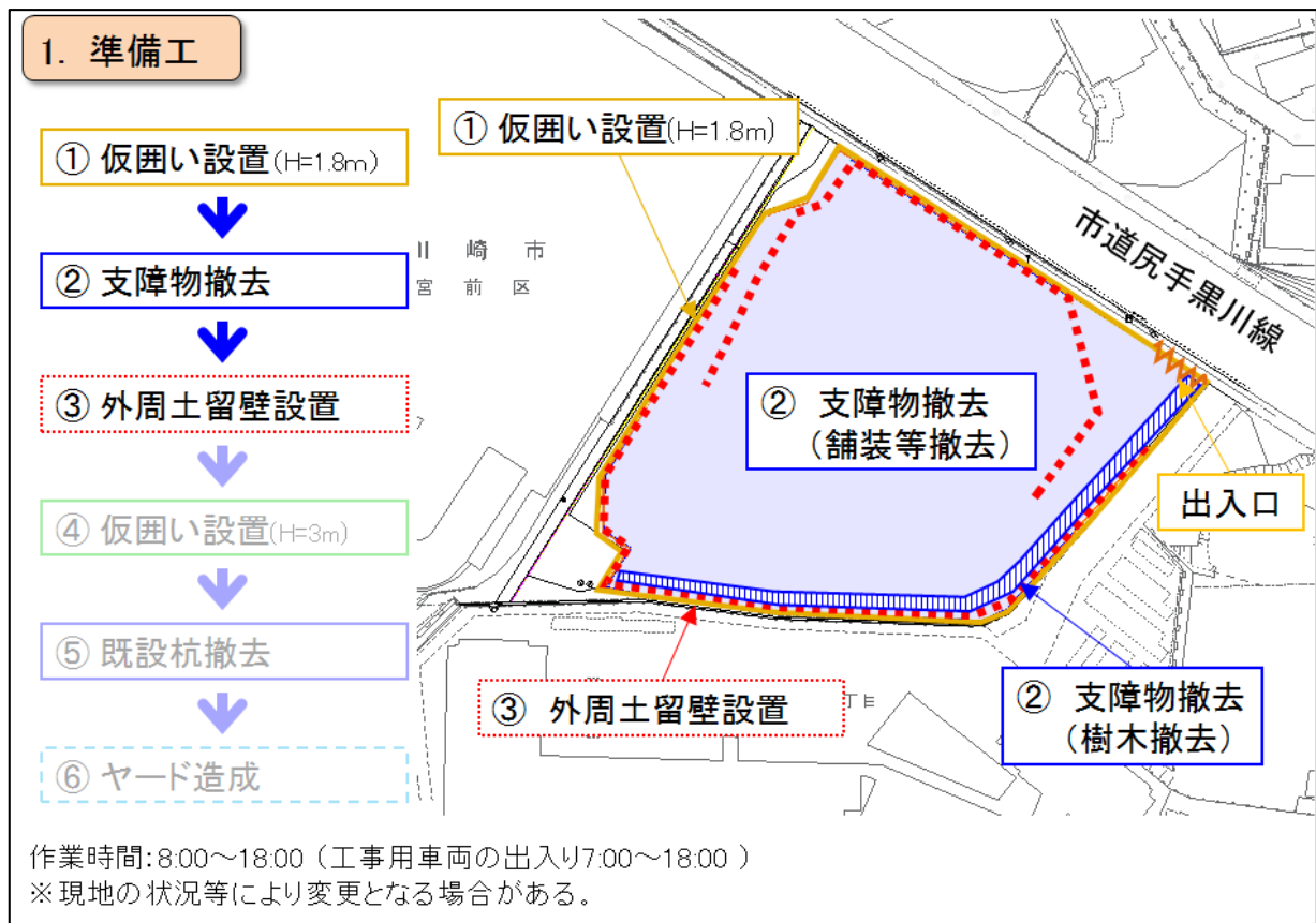
図 2-5(1) 準備工の施工手順①
