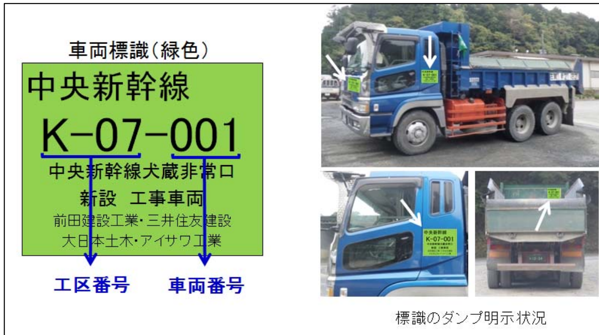
図 3-5 工事用車両標識の明示
