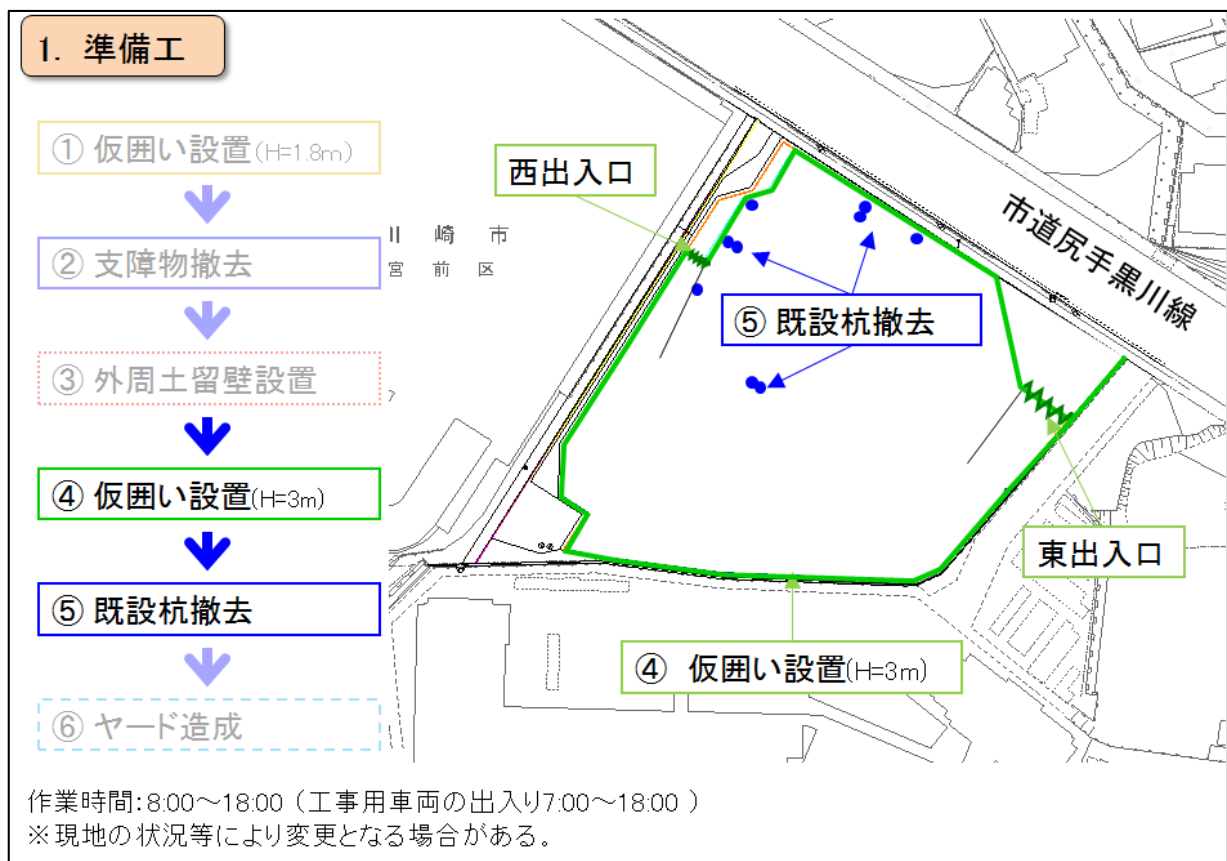
図 2-5(2) 準備工の施工手順②
