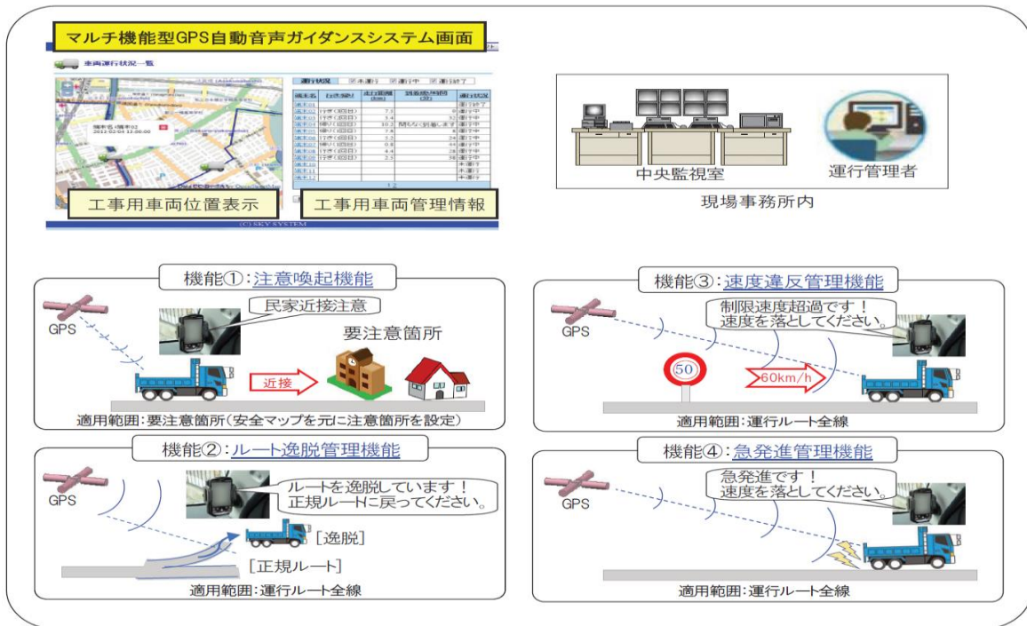
図 2-6-5 マルチ機能型 GPS 音声自動ガイダンスシステム概要
