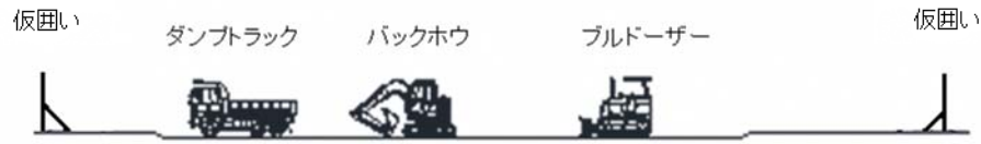
図 2-3-3 (1) 可児市内大森発生土仮置き場における主な施工手順（土地の整地）
