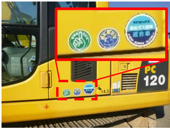
写真4-1-11 排出ガス対策型、低騒音型 建設機械の稼働
