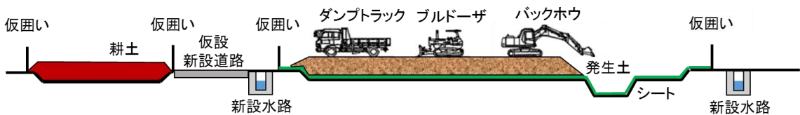
図 2-3-1(3) 仮置き場 A における主な施工手順 (仮囲い設置・シート敷設)
