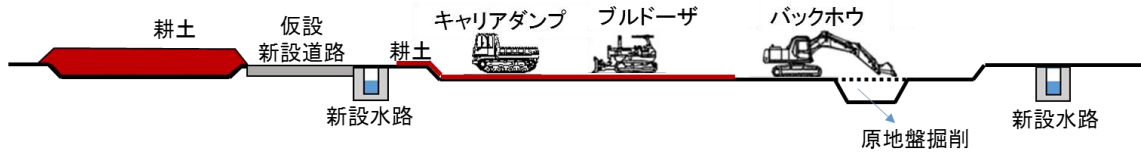
図 2-3-1(2) 仮置き場 A における主な施工手順 (耕土鋤取り・地盤置き換え)
