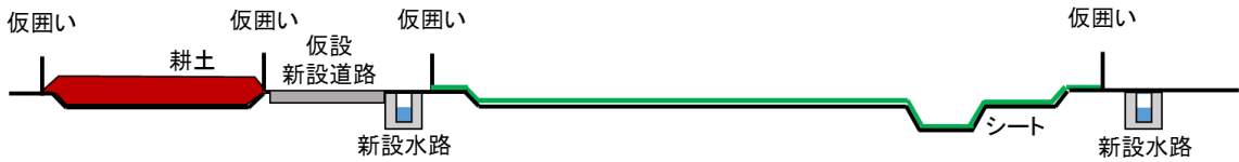
図 2-3-1(3) 仮置き場 A における主な施工手順 (仮囲い設置・シート敷設)
