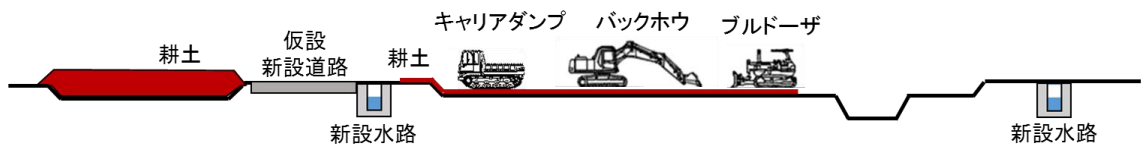
図 2-3-1(6) 仮置き場 A における主な施工手順 (農地 原状回復)
