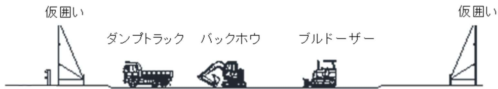
図 2-3-3(1) 瑞浪市内土岐町発生土仮置き場における主な施工手順（土地の整地）
