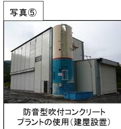
図3-4-1-1 工事施工ヤード等における大気環境に関する計画面の環境保全措置 (写真は類似工事の例)
