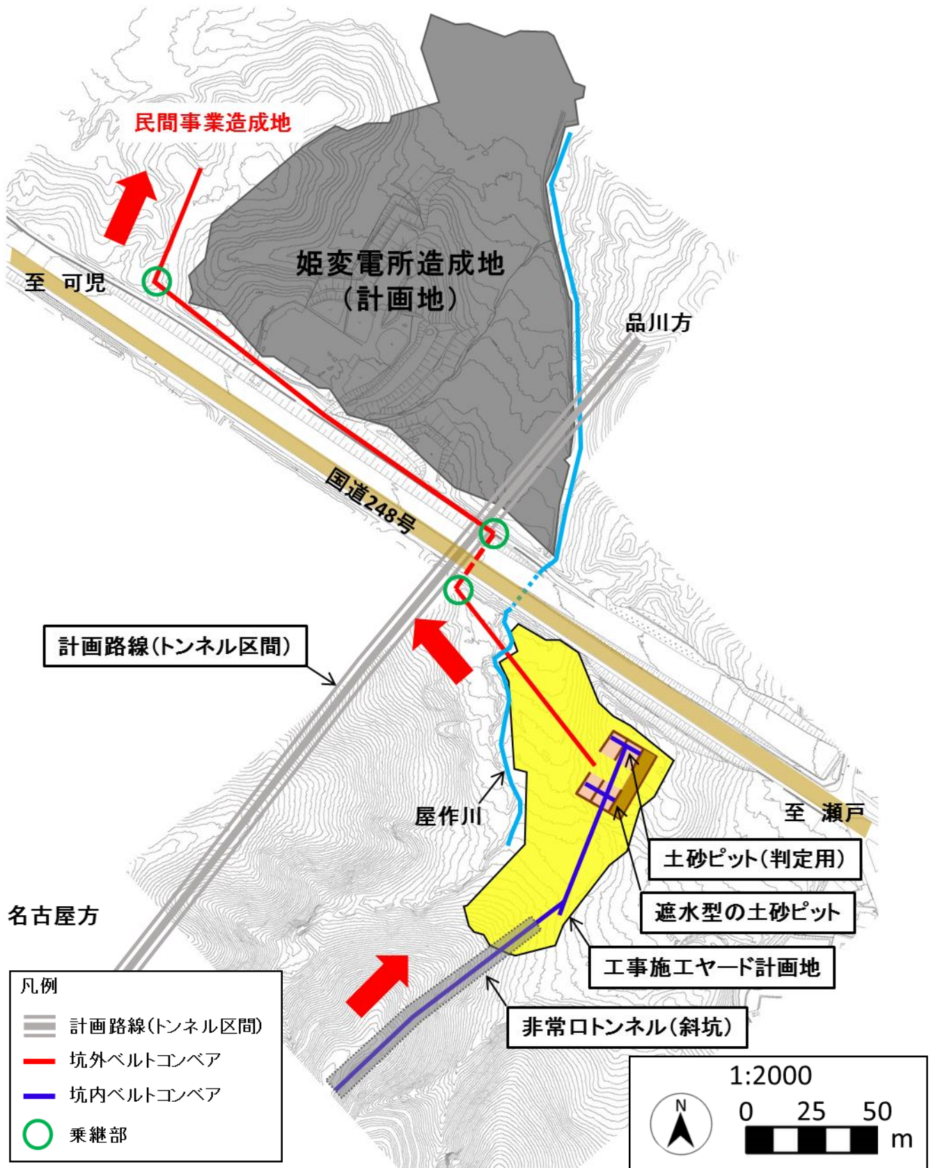
図 2-3-2-2 ベルトコンベアの設備配置図
