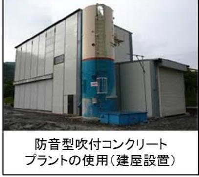
防音型吹付コンクリートプラントの使用(建屋設置)
