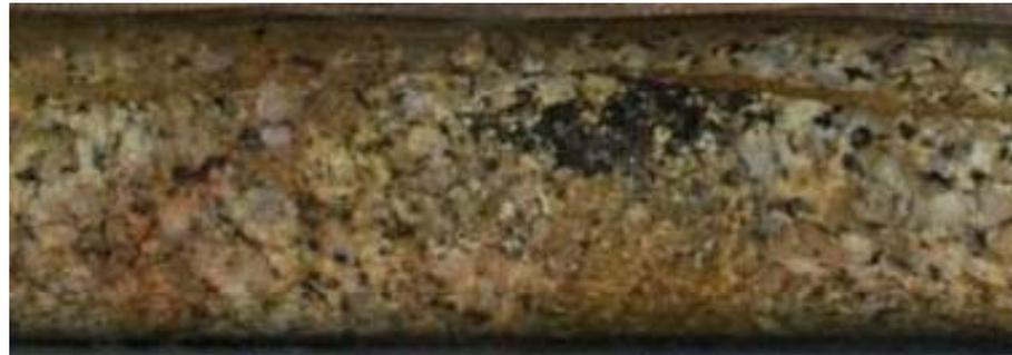
＜ボーリング調査(猿庫<sup>さくら</sup>の泉付近)の採取試料写真＞ 深層部(地表から約100m)
