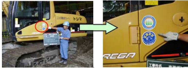
・排出ガス対策型建設機械の稼働 ・低騒音・低振動型建設機械の採用
