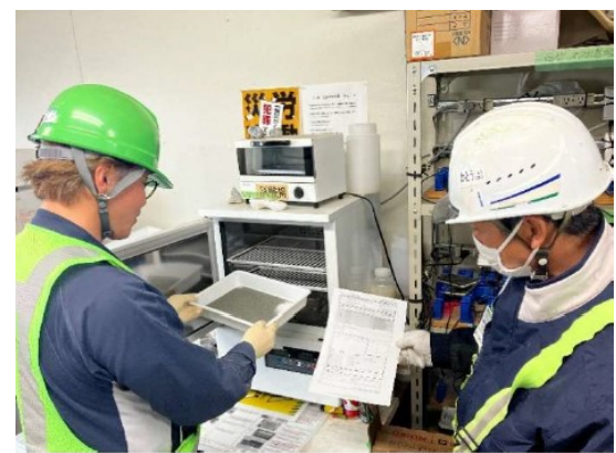
写真 4-1-2-11 有害物質の有無の確認と汚染 土壌の適切な処理 発生土に含まれる重金属等の 定期的な調査
