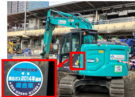
写真 4-1-5-2 排出ガス対策型建設機械の採用
