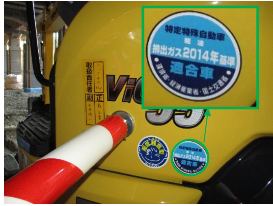
写真4-1-6-2 排出ガス対策型建設機械の採用
