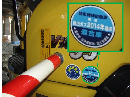
写真3-1-3-2 排出ガス対策型建設機械の採用
