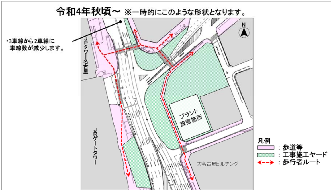
図 2-9 (3) 工事施工ヤード (名駅通周辺)
