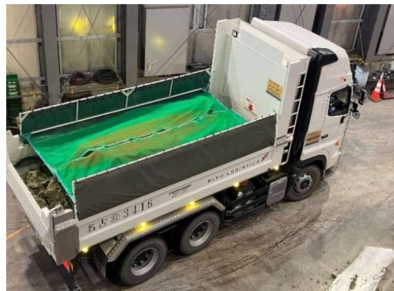
写真 7-1-1-6 荷台への防じんシート敷設
