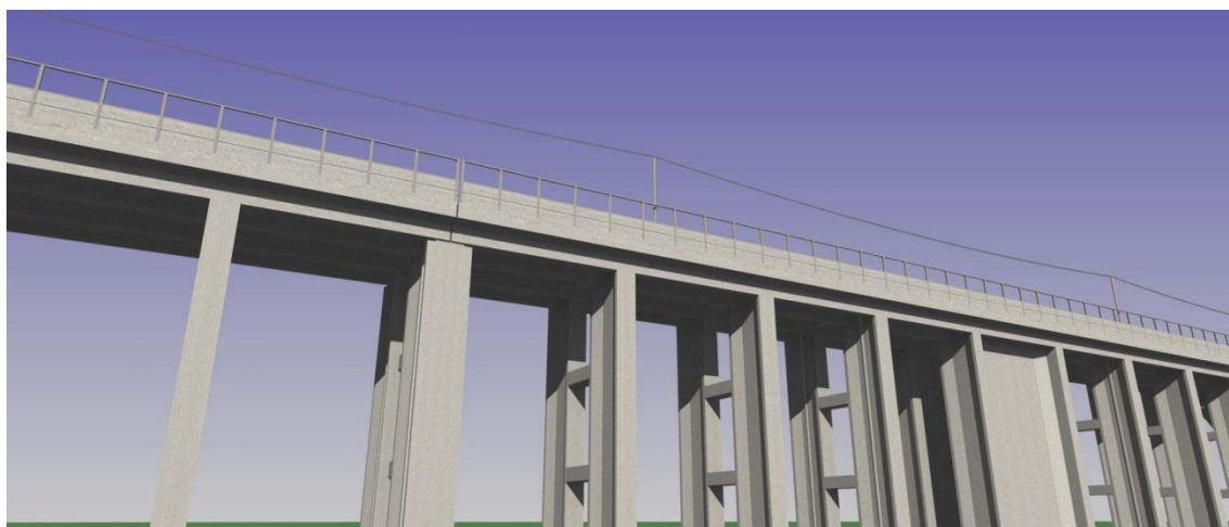
図 13-1-2-3 新形式高架橋（防音壁部）
