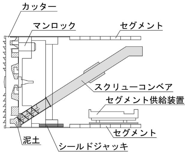
図 3-4-2-20 土圧式シールド機械（断面図）
