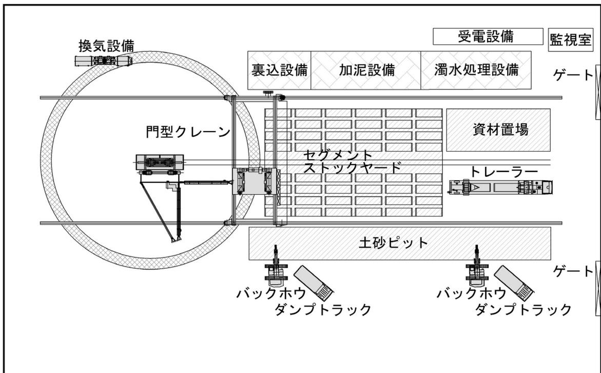
図 3-4-2-26 非常口の施工ヤードの概要（土圧式シールド工法によるトンネル施工時）
