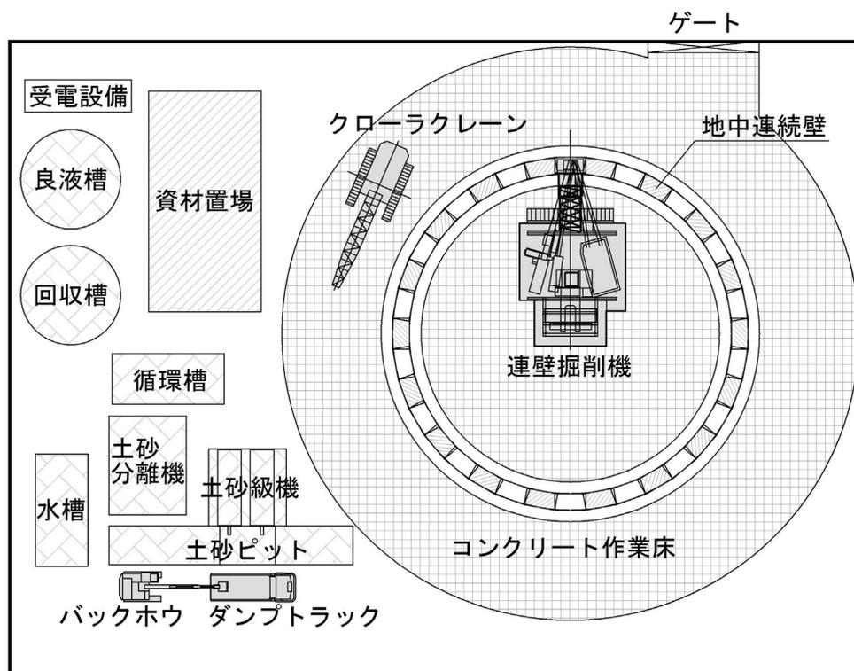
図 3-4-2-23 非常口の施工ヤードの概要 (RC 地中連続壁工法による非常口施工時)
