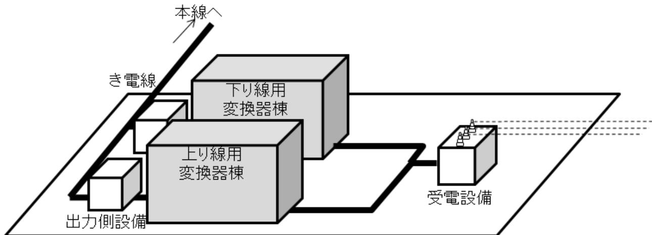
図 3-4-2-11 変電施設の概要
