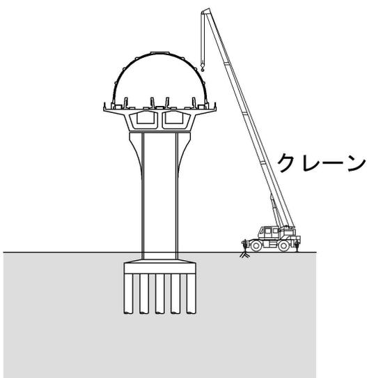
図 3-4-2-12 高架橋部における施工概要
