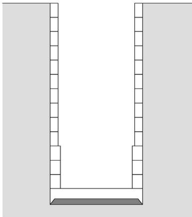
図 3-4-2-22 非常口の施工概要 (ケーソン工法の場合)
