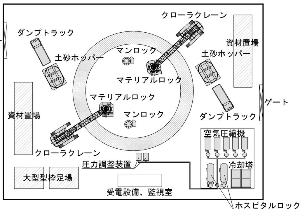
図 3-4-2-24 非常口の施工ヤードの概要 (ケーソン工法による非常口施工時)
