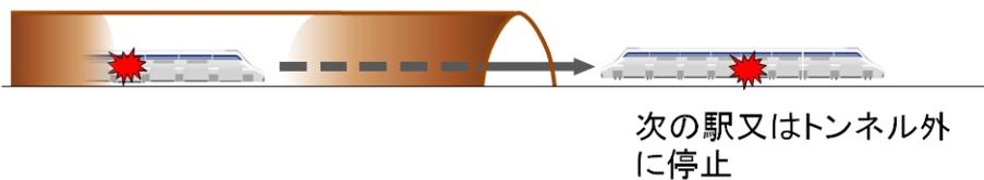
図 3-4-5-9 トンネルでの火災時の対応の概要
