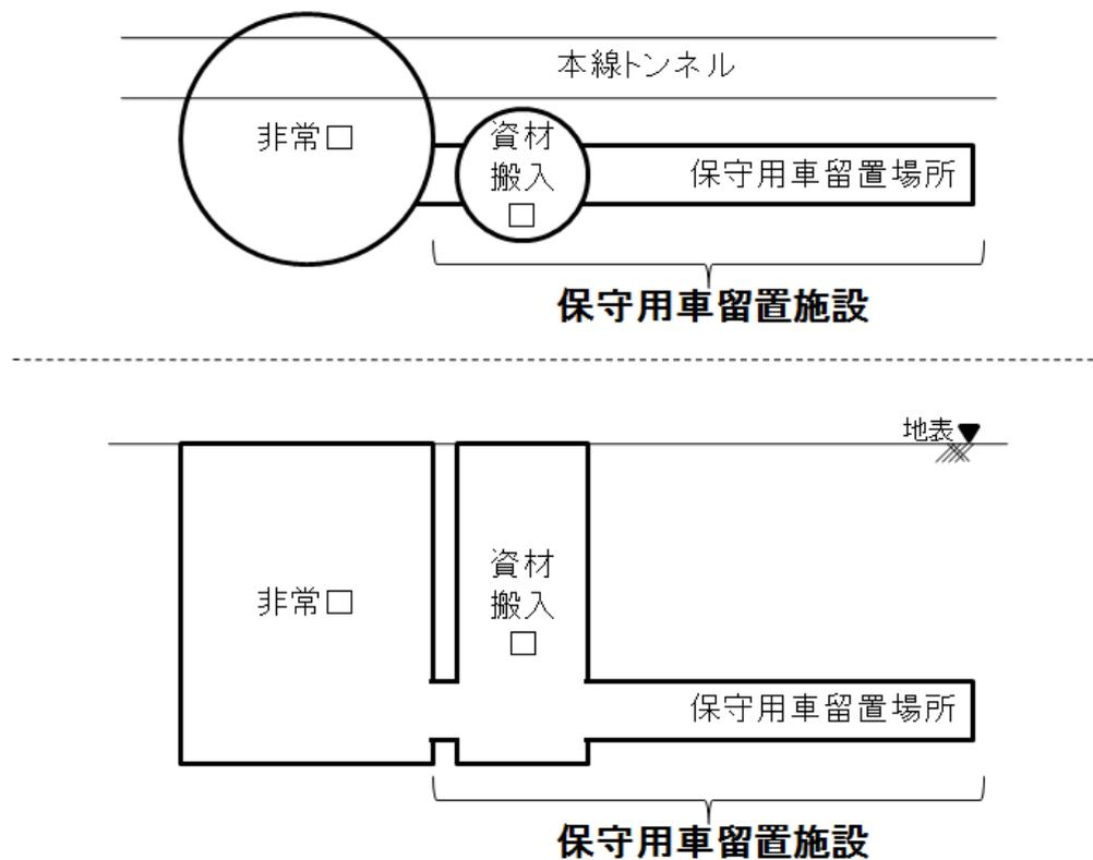
図 3-4-2-10 保守用車留置施設の概要（上段が平面図、下段が側面図）
