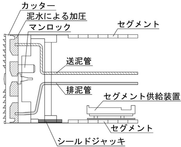
図 3-4-2-19 泥水式シールド機械（断面図）
