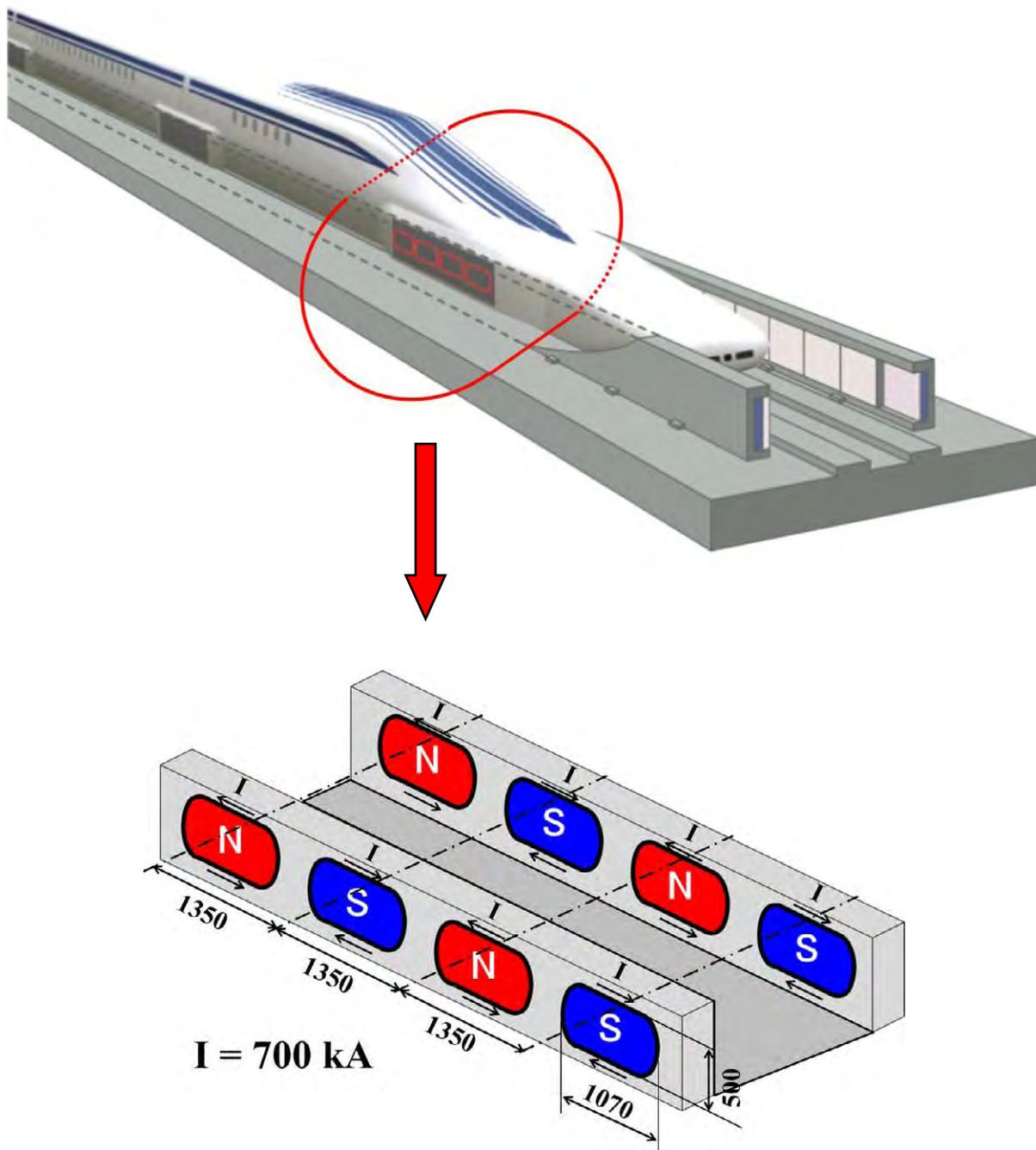
図 9-7-1-2 超電導磁石を拡大した概略図（磁界の算出にあたっての前提条件）
