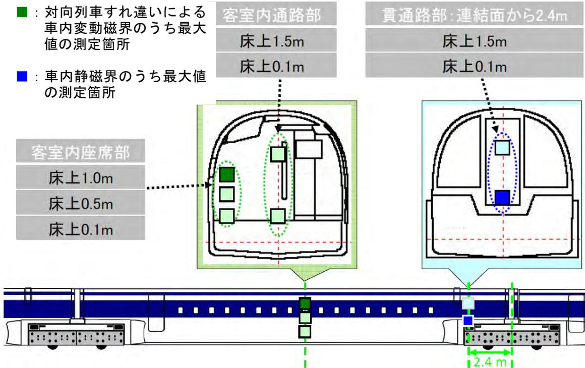
図 9-5-3 車内の磁界の測定箇所
