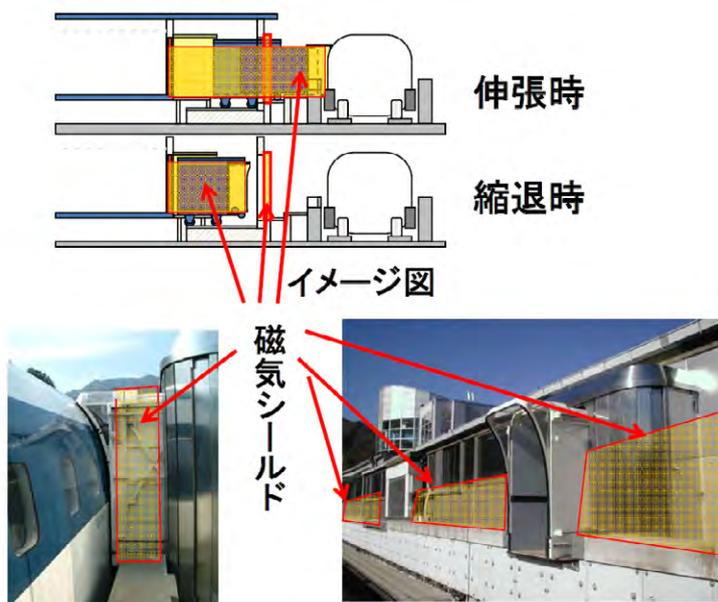
図 9-5-2 ホームへの磁気シールド設置の概念図
