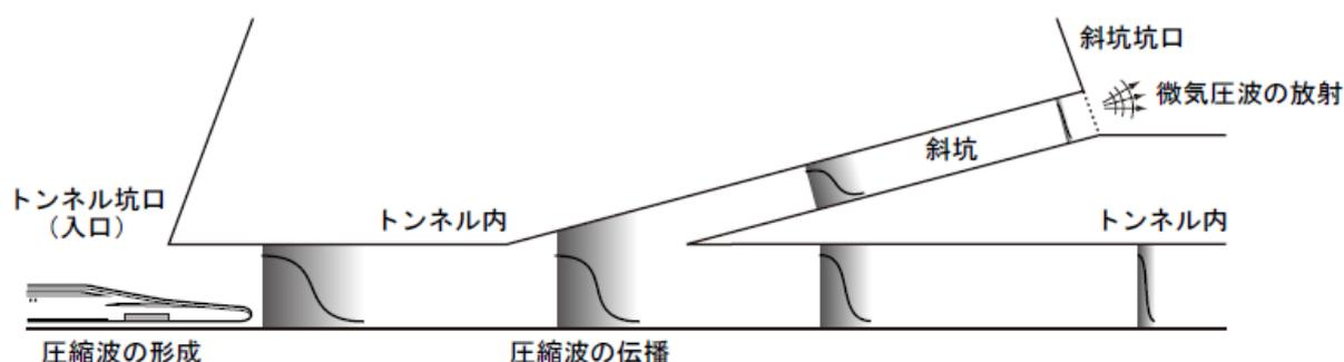
図 3-3-14(2) トンネル微気圧波発生メカニズム (斜坑)
