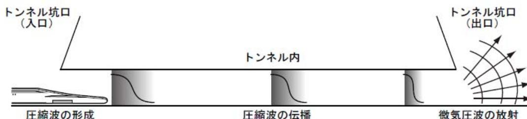
図 3-3-14(1) トンネル微気圧波発生メカニズム (山岳トンネル)
