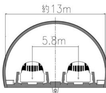
図 3-3-10 山岳トンネルの標準的な断面図
