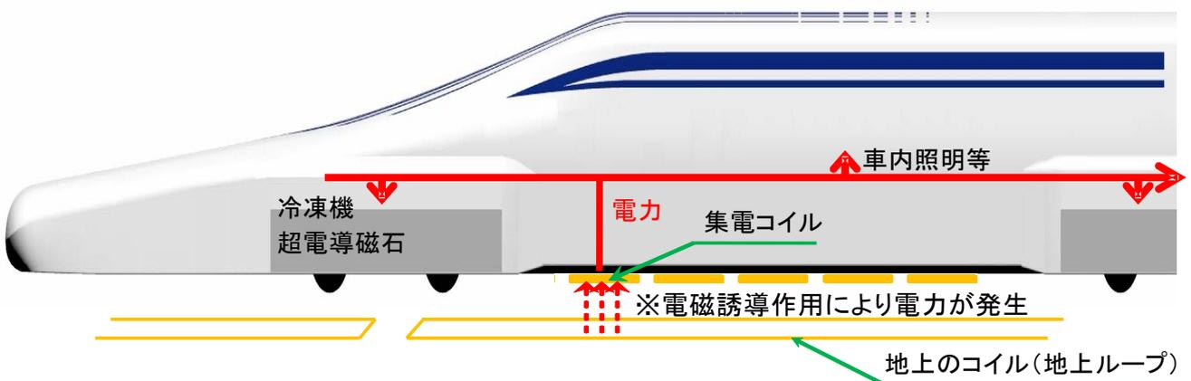
図 3-3-13 車上電源供給のイメージ
