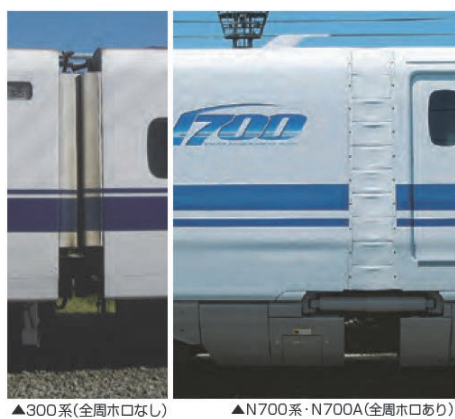
図 19-4-2-2 車両の平滑化による走行抵抗の低減の一例
