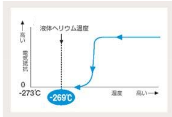
図 3-4-18 電気抵抗と温度の関係
