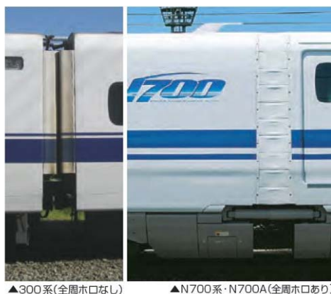
図 17-3-4 車両の平滑化による走行抵抗の低減の一例
