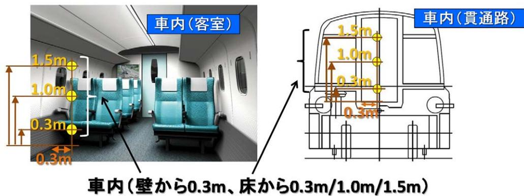
図 12-5-3 車内の磁界の測定箇所
