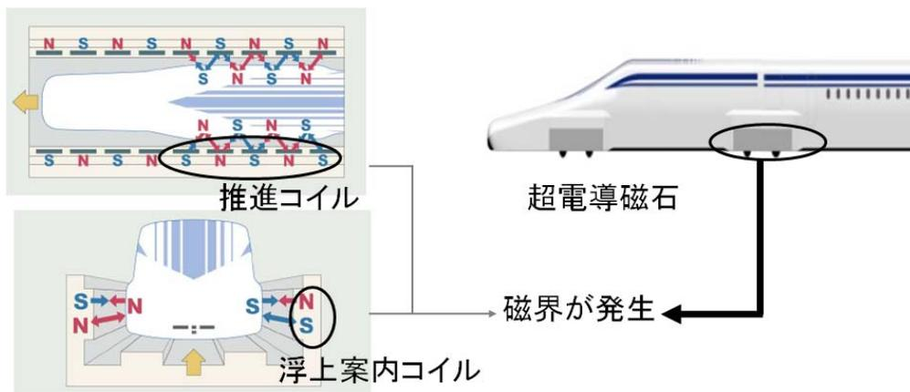
図 12-9-4 超電導リニアによる磁界の発生源
