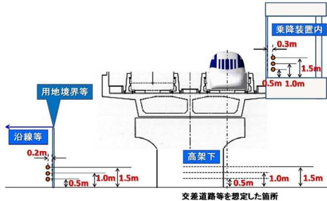
[車上計測点] 床から 0.3/1.0/1.5m、壁から 0.3m
