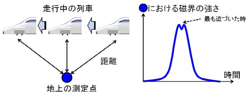
図 12-9-5 走行中の列車から発生する磁界のイメージ(超電導磁石が1つ通過する場合)
