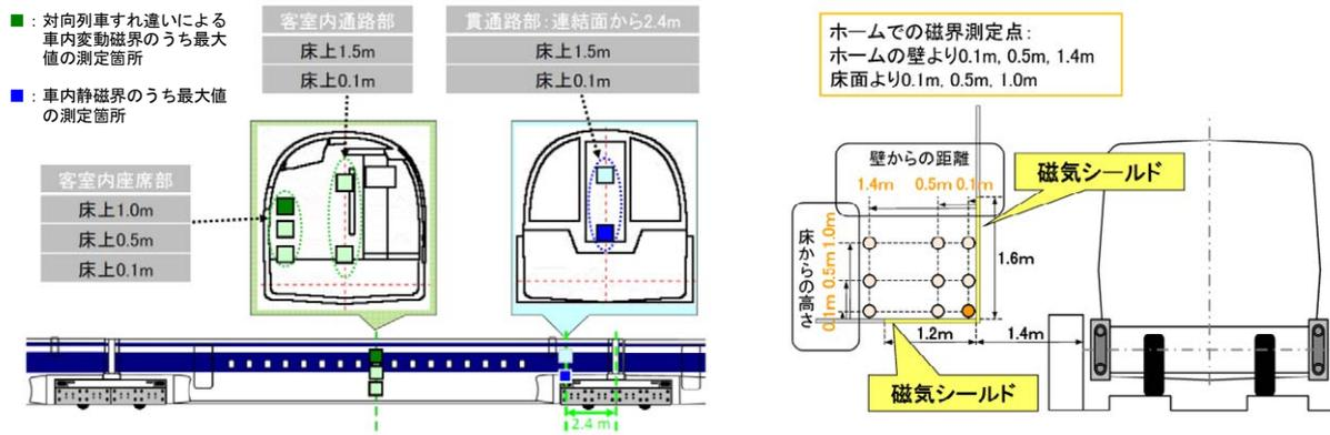
図 12-5-6 車内の磁界の測定箇所
