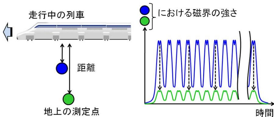
図 12-9-7 走行中の列車から発生する変動磁界のイメージ
