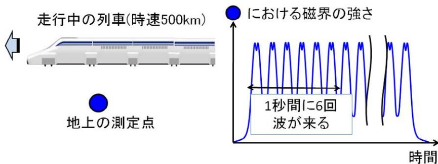
図 12-9-6 走行中の列車から発生する変動磁界のイメージ
