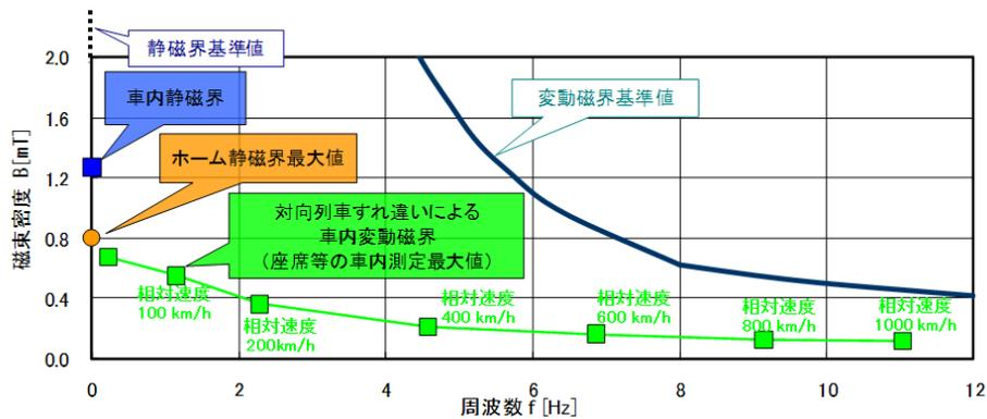
図 12-5-8 車内及びホームの磁界の測定結果
