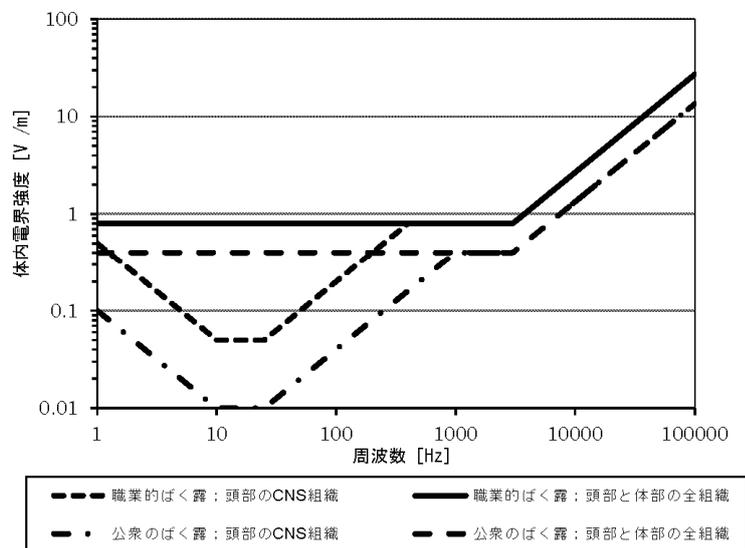
図1. CNSおよびPNSへの影響に係わる体内電界強度に基づく公衆ばく露と職業的ばく露に対する基本制限
