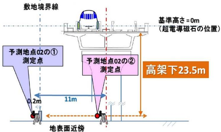
※高架橋高さ約 25 m の地上高さ 1.5 m = 高架下 23.5 m
