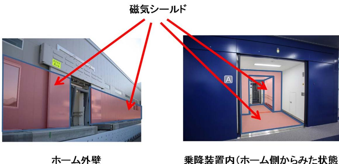
図 12-5-2 ホームへの磁気シールド設置の概念図
