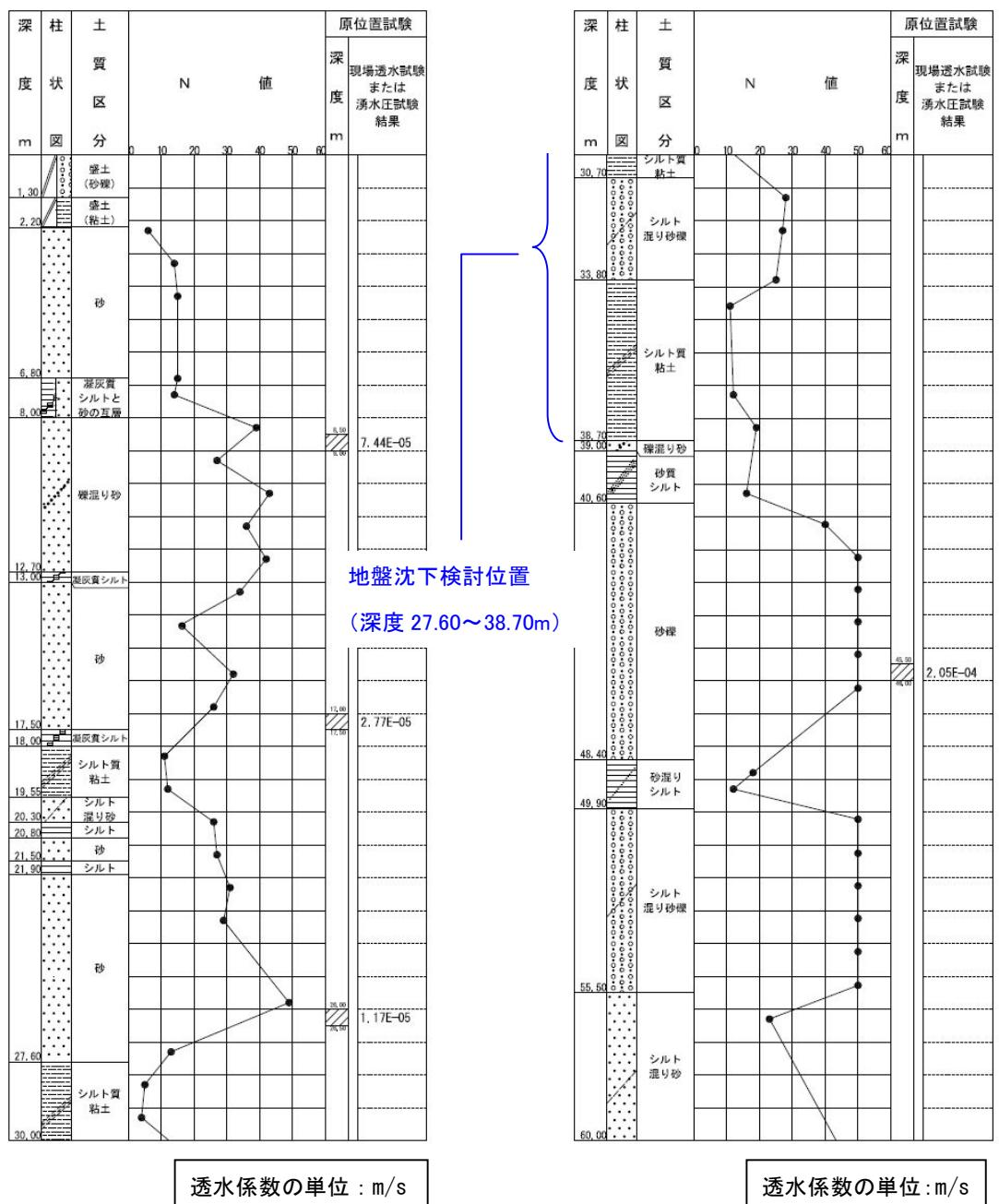
図 8-2-3-1(1) 地質柱状図 (地下駅付近)
