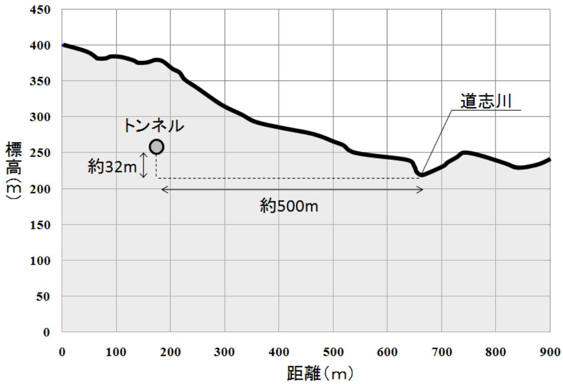
図 8-1-4 道志川とトンネルの位置関係 (C-C' 断面)
