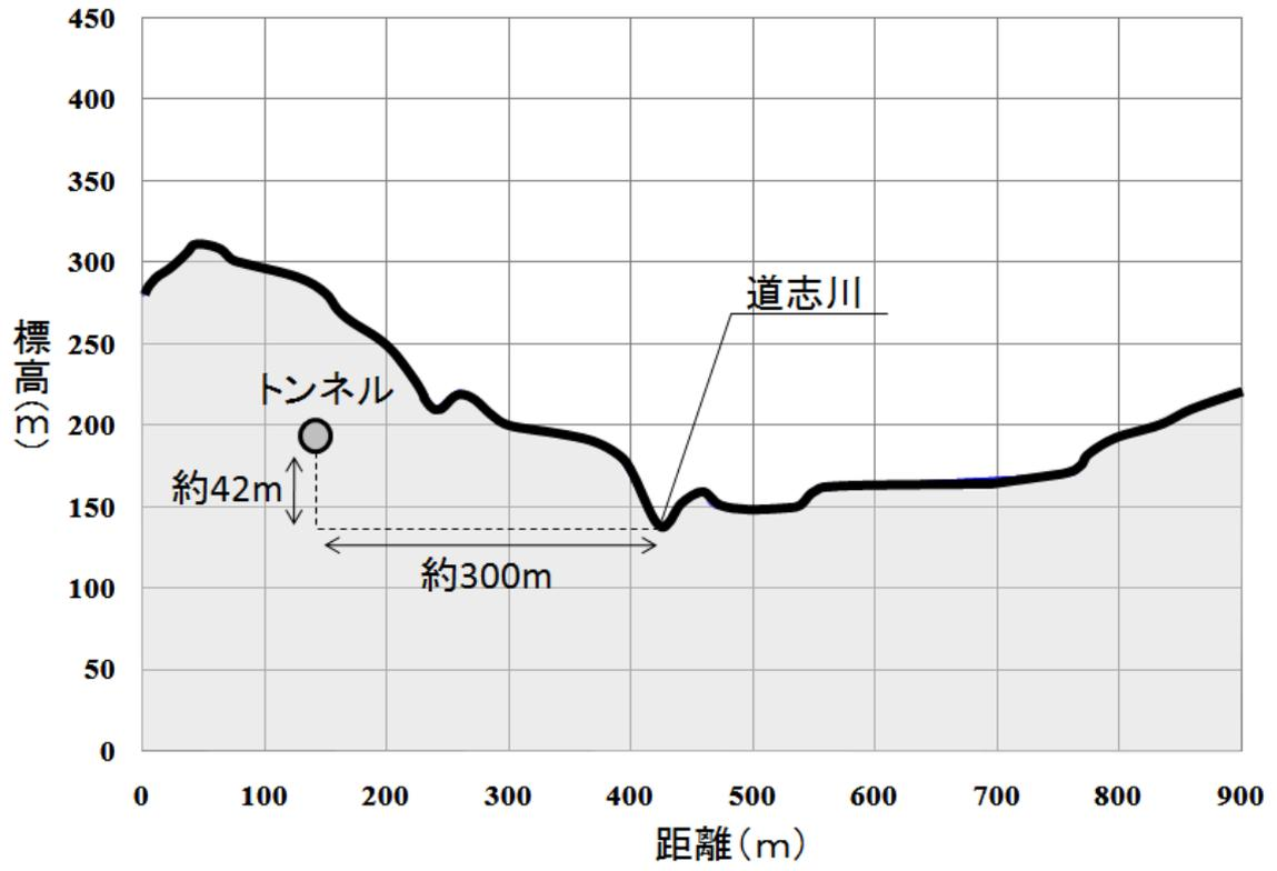
図 8-1-2 道志川とトンネルの位置関係 (A-A' 断面)
