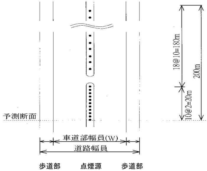
② 断面図(点煙源は、道路中央で路面から1mの高さに置く。)
