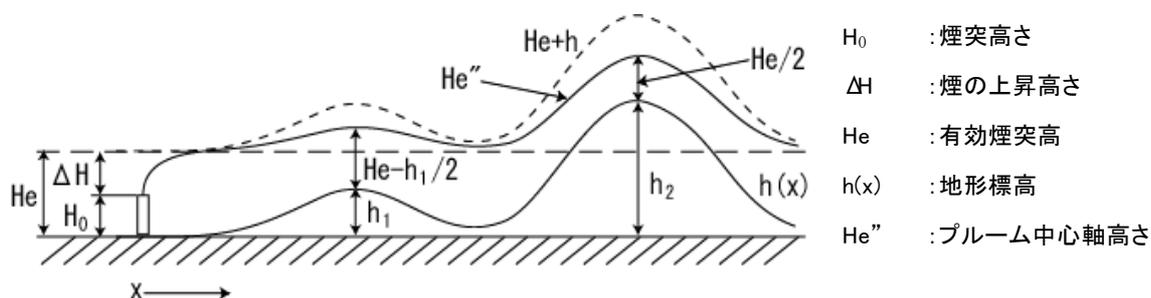
図 8-1-1-5 ERT の PSDM モデルの概念図
