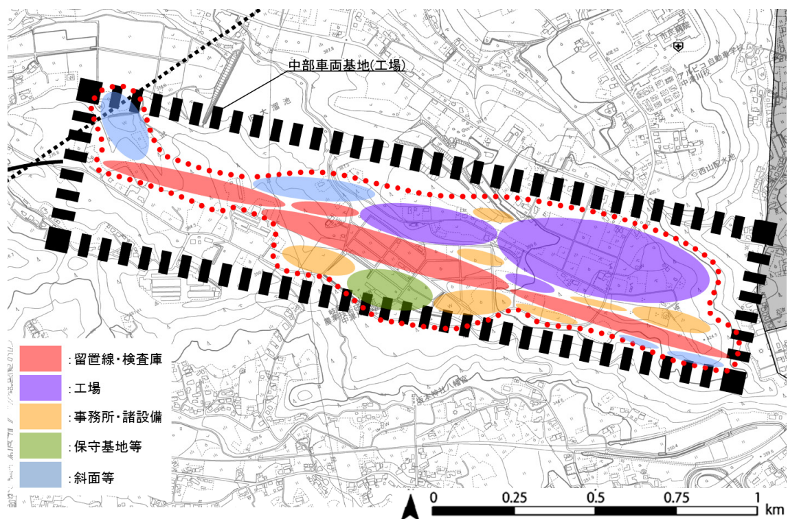
図 4-2-1 車両基地の設備配置の概要
