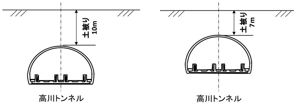
図 8-1-3-16 測定を行ったトンネルの諸元
