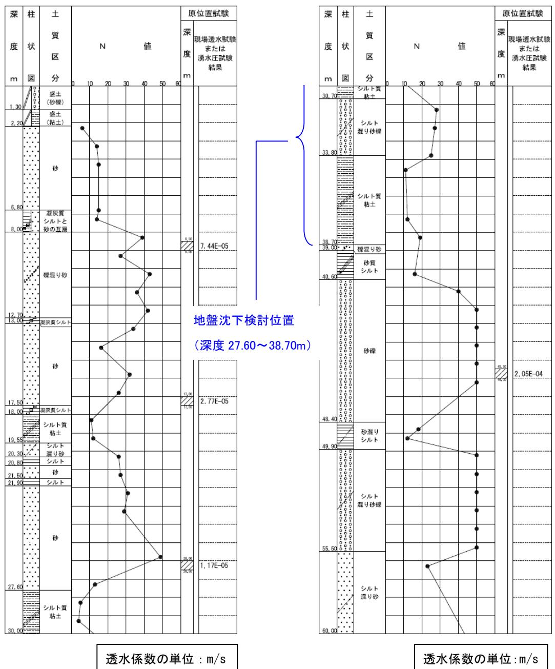
図 8-2-2-1(1) 地質柱状図（地下駅付近）
