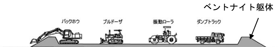
図 2-5 (1) 塩島地区（南）発生土仮置き場における主な施工手順（ベントナイト躯体設置）
