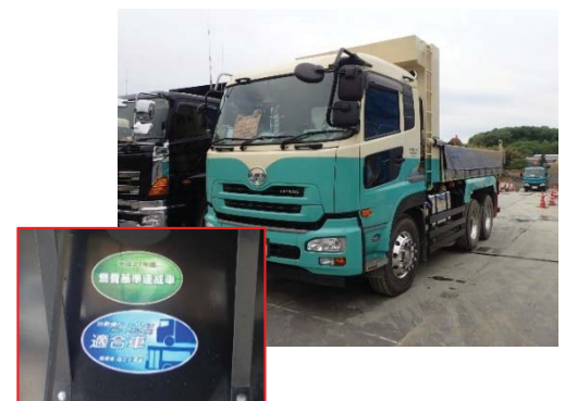
写真-5-3 低公害型の工事用車両の状況 (小野路非常口)
