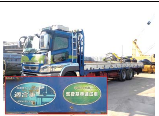
写真-5-1 低公害型の工事用車両の状況 (品川駅)
