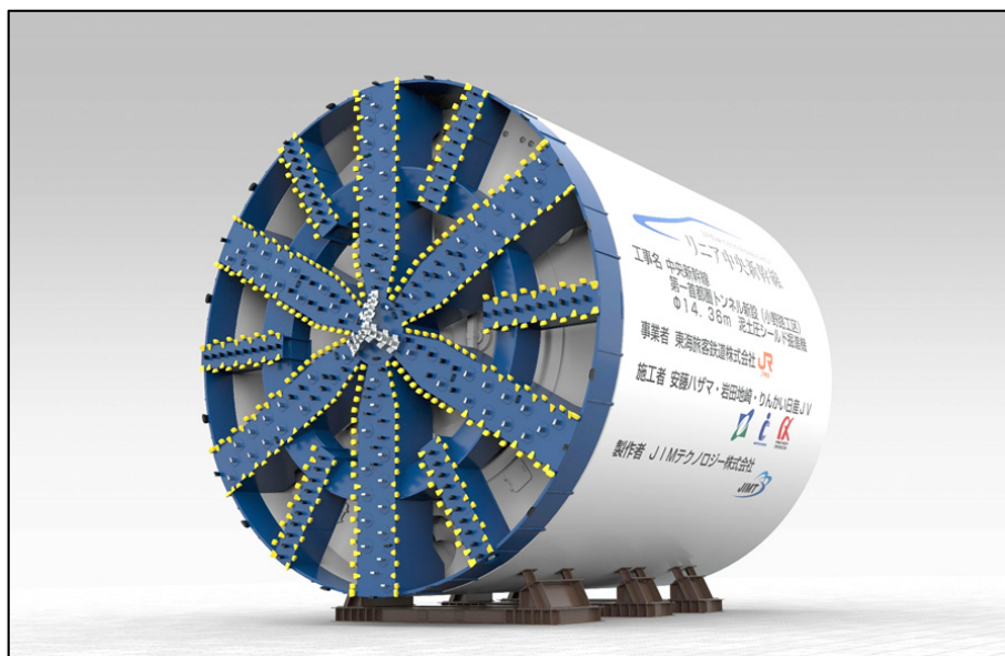
図 2-4 小野路非常口に搬入するシールド機
