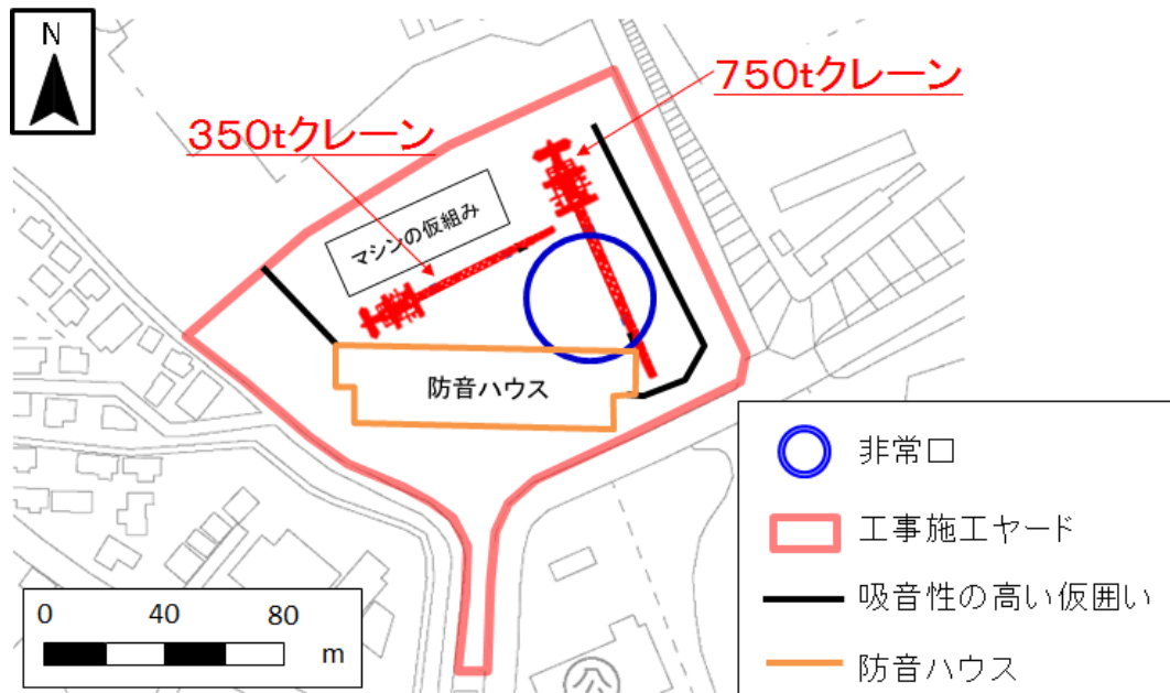
図 2-6 地上でのシールド機の仮組み
