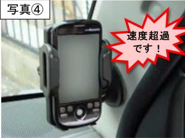
発生土及びセグメント運搬車両に「GPS運行管理システム」を搭載。運行管理システムは、運行ルート上の注意箇所接近したときや走行速度が制限速度を超えた時に、運転手に対して音声等により注意喚起を行い、ヒューマン・エラーに起因する交通事故の発生を防止します。
