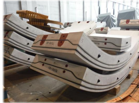
セグメント置場
