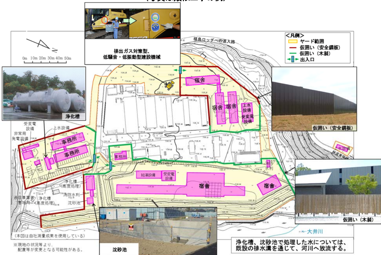
図 3-10(3) 動物・植物・生態系に関する環境の計画面の環境保全措置（嵯島） （写真は類似工事の例）
